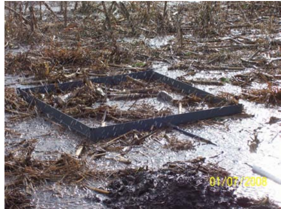
Figura 1b: Parcela de escurrimiento con intensidad de 70 \text{ mm h}^{-1} y 1 h de aplicación.
